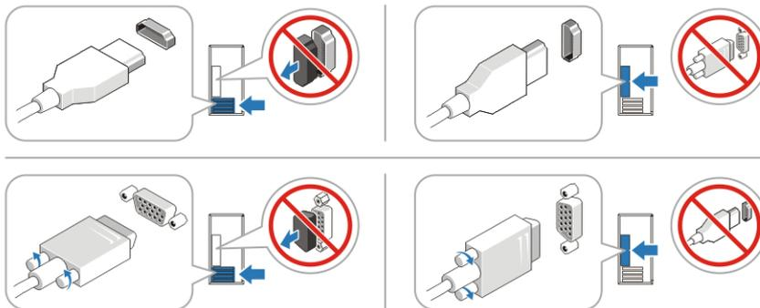
**Figura 5. Connettore VGA e connettore HDMI**
